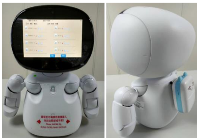
圖六：智能互動機器人搭載藍芽打印機
