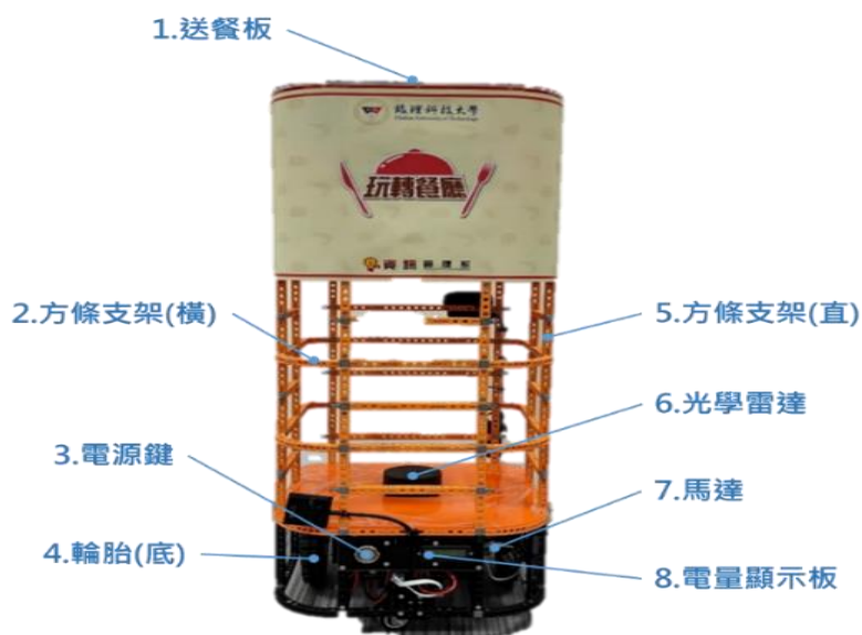
圖四：AGV無人送餐車整體結構圖
